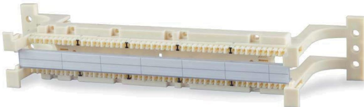
Кросс-панели 110 типа применяются для разделки на них кабелей различных подсистем СКС. Основным преимуществом 110 кроссов является возможность коммутации непосредственно каждой пары проводников по отдельности, что обеспечивает высокую гибкость при изменении конфигурации системы. Межсоединения осуществляются коммутационными шнурами и перемычками.
