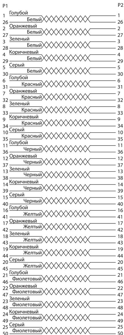
Коммутационные шнуры с разъемами Telco (RJ-21/Amphenol) снабжены 50-ти контактными модульными разъемами и используются при монтаже АТС для 25-проводных (или менее) телефонных подключений, для группового подключения портов Ethernet и xDSL к сетевому оборудованию, а также (с пружинными защелками) в интерфейсе SCSI-1.
