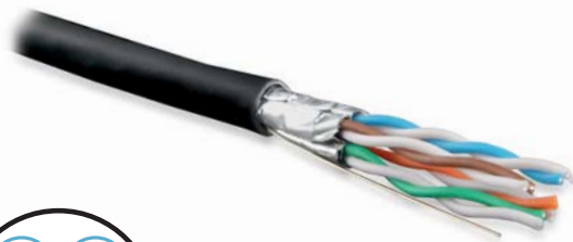
Внешняя оболочка Дренажный провод Экран-фольга Витая пара solid Рипкорд
